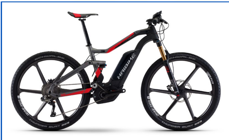
Haibike Xduro FullSeven 10.0: Full karbon (még a kerekek is), D12 elektromos váltó
