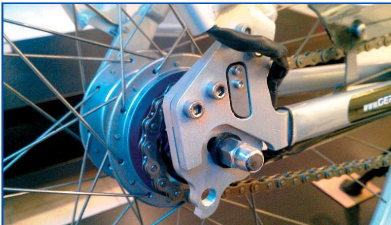
Nyomatékszenzor a hátsó villánál
