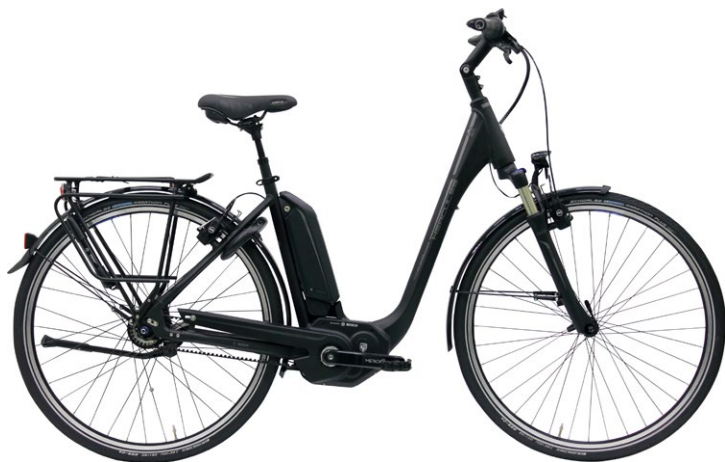
Hercules Futura Gates: szíjhajtással az olajos láncok ellen
