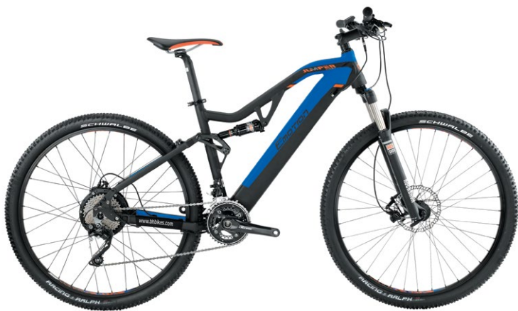
BH EVO Jumper 29: új vázforma, 600 Wh-ás akkumulátorral és új kijelzővel
