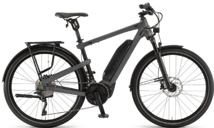
Winora Yakun Tour: 20 sebességes váltóval és az új PWX2 motorral
