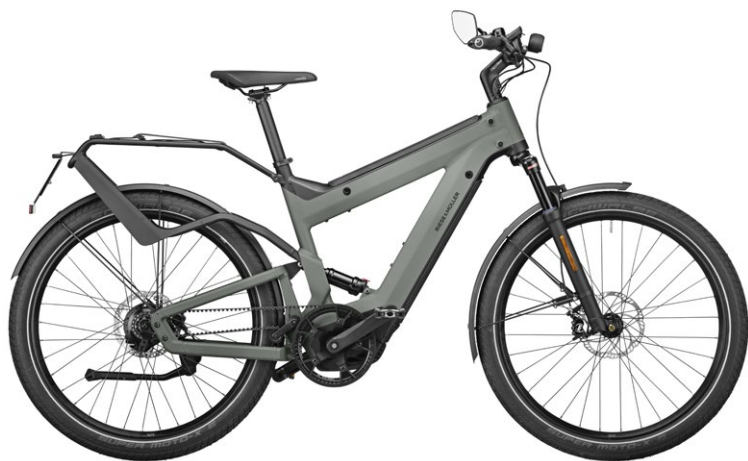
RM Superdelite GT Rohloff HS: 14 sebességű elektromos váltóval
