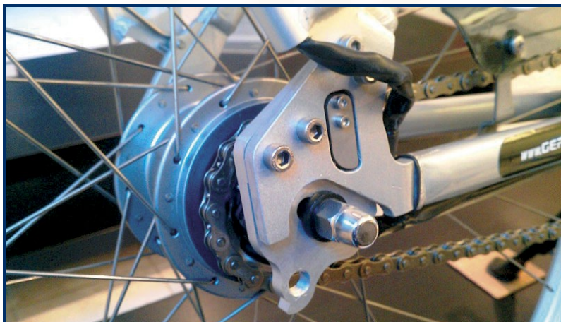
Nyomatékszenzor a hátsó villánál
