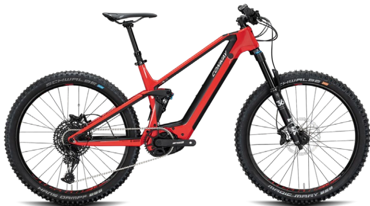
Conway Xyron 727: karbon vázzal, Fox rugókkal
