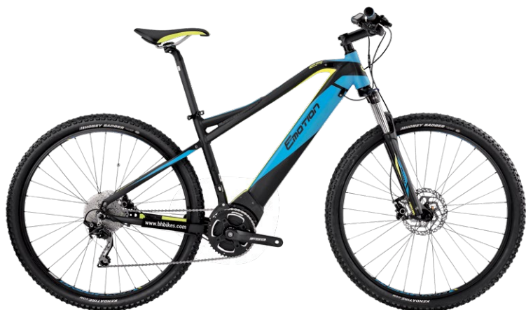
BH Evo sorozat – vázba épített akkumulátorral
