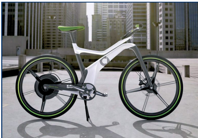
Smart egyedi hátsókerék hajtással, 3 sebességes agyváltóval
